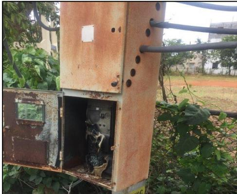
Figure 4: Meter Burnt Out (MBO)
